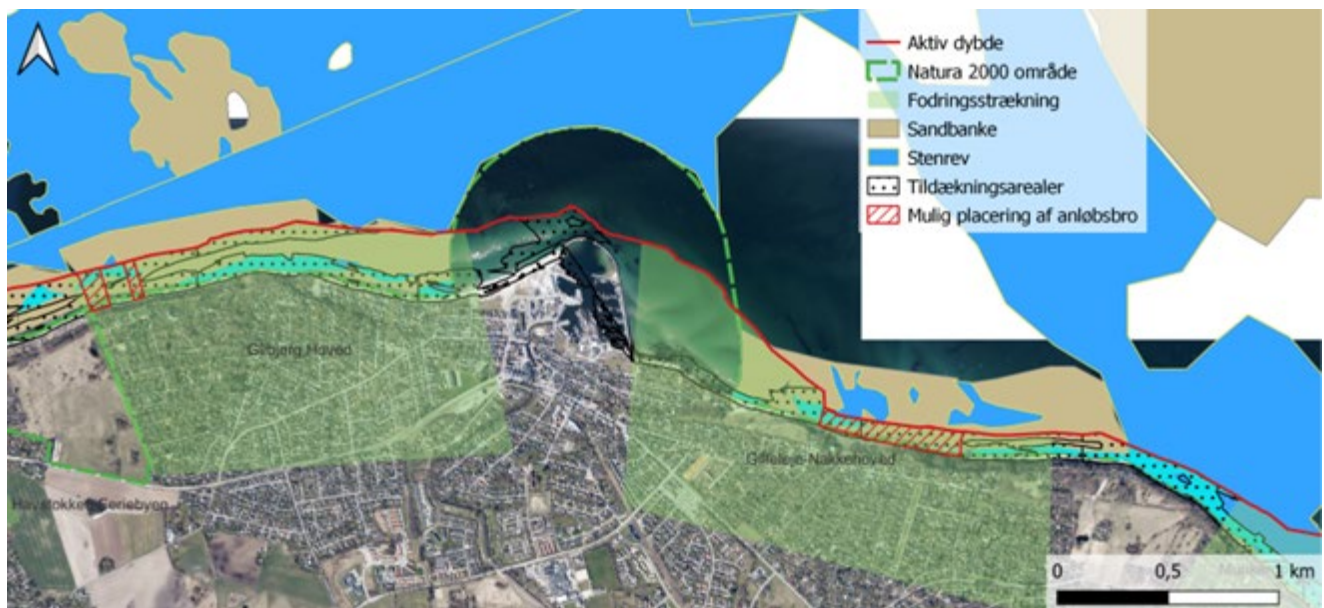
Figur 7.5: Mulig placering af anløbsbroer til indsejlning af ral ved fodringsstrækningerne Gilleleje-Nakkehoved og Gilleleje-Nakkehoved. De mulige placeringer strækker sig fra vandlinjen og ud til den aktive dybde, ortofoto 2021.
