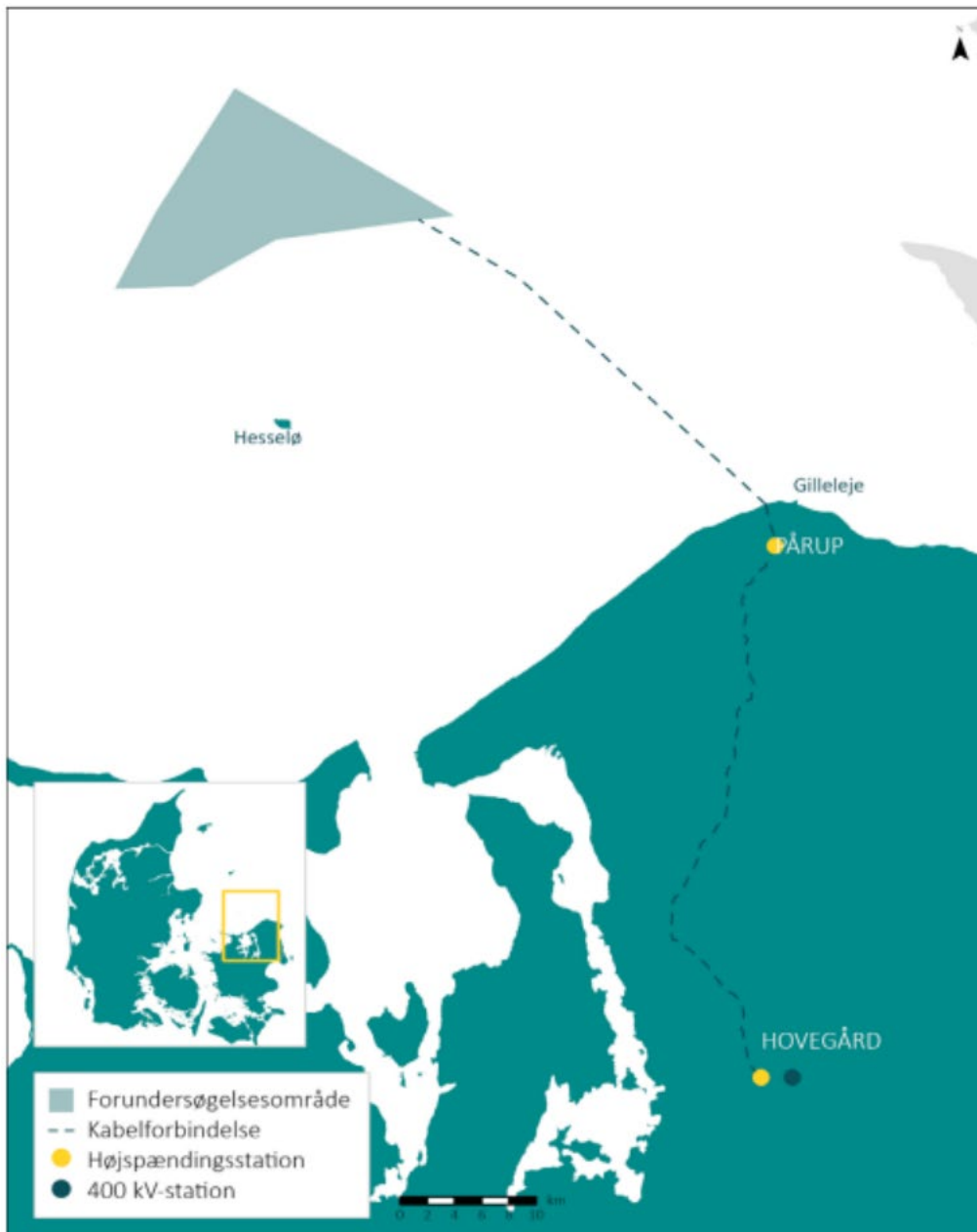
Figur 10.1: Figuren viser placering af Hesselø Havvindmøllepark og kabelrute på havet og på land (Energistyrelsen, 2024b).
