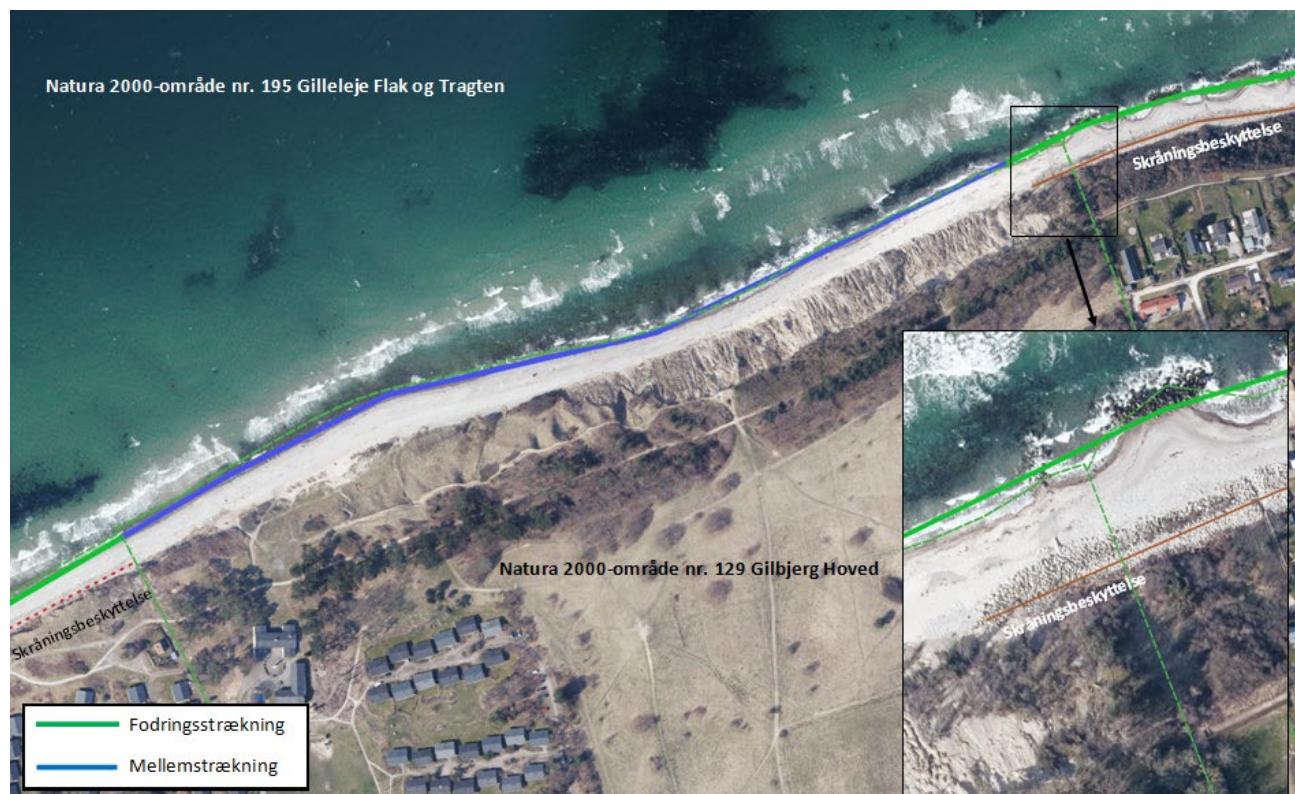
Figur 7.8: Figuren viser Natura 2000-område nr. 129 Gilbjerg Hoved med eksisterende skråningsbeskyttelse på hver side, og zoom af starten af fodringsstrækningen fra Gilbjerg Hoved til Gilleleje Havn (tyk grøn streg). Mellemstrækningen foran Natura 2000-området er vist med tyk blå streg, og fodringsstrækning Havstokken-Feriebyen med tyk grøn streg. Natura 2000-grænserne er vist med stiplede grønne streg.
