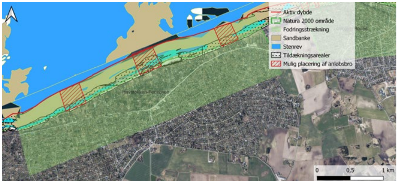
Figur 7.4: Mulig placering af anløbsbroer til indsejlning af ral ved fodringsstrækningen Havstokken-Feriebyen. De mulige placeringer strækker sig fra vandlinjen og ud til den aktive dybde, ortofoto 2021.
